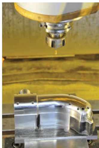
Чистовая обработка пуансона для пресс-формы
